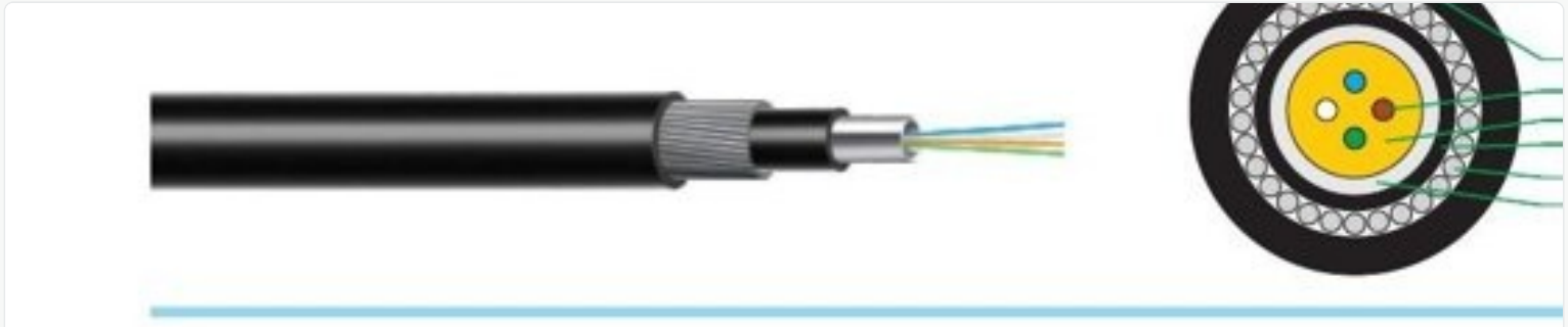
Câble fibre-vers-antenne (FTA) — solution pour stations radio de base, armure acier tressé, ruban polyester, gaine LSZH.
